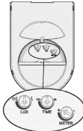
Vous pouvez faire pivoter le capteur horizontalement sur 25° afin d'adapter l'orientation de la détection.
